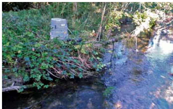
Mise en place de préleveurs automatiques pour évaluer l'impact de l'élevage sur la rivière Douron en septembre dernier.
